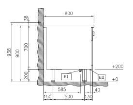
Electrical inlet (power) Equipotential screw
